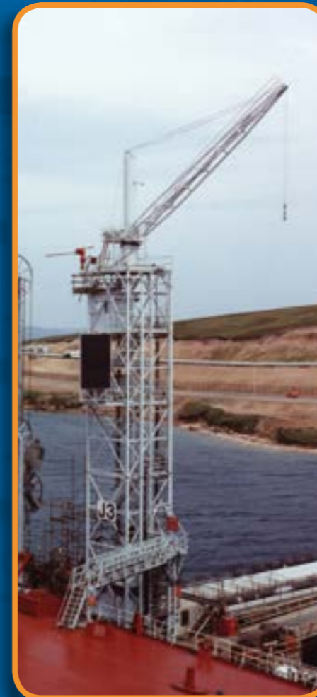
پلکانهای دسترسی مدل برچی چند منظوره جهت سائورت IDASAT ها، کابین ها و سیستمهای کنترل دریق استفاده میشوند Shetland Islands - Sullom Voe
