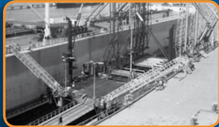
Vopak Europort - Netherlands اولین سازه های مجهز به نردبان تلسکوپی که اولین بار در سال ۱۹۶۸ عرضه شدند- که از آن تاریخ تاکنون هر روزه مورد استفاده قرار میگیرد.
