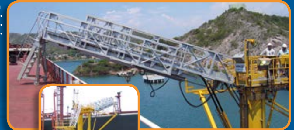
سیستم کنترل پل شرکت VERHOEF دارای دستگیره ها با بر چسب شفاف میباشد که باعث میشود کار را با پلکان دسترسی آسان باشد - Venezuela PDVSA
